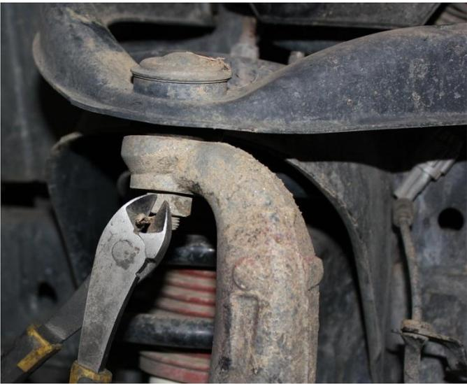
8) Loosen outer tie rod nut.
